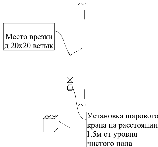
АксонOMETрическая схема внутреннего газоснабжения после перепланировки:
